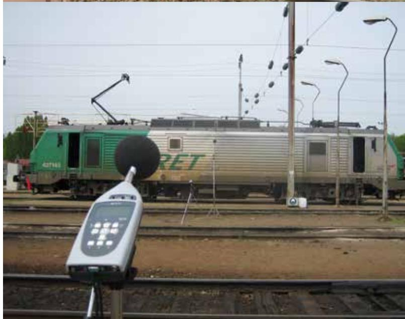
Photos: SONOMÈTRE ET STATION AUTOMATIQUE AUX ABORDS DES LIGNES
