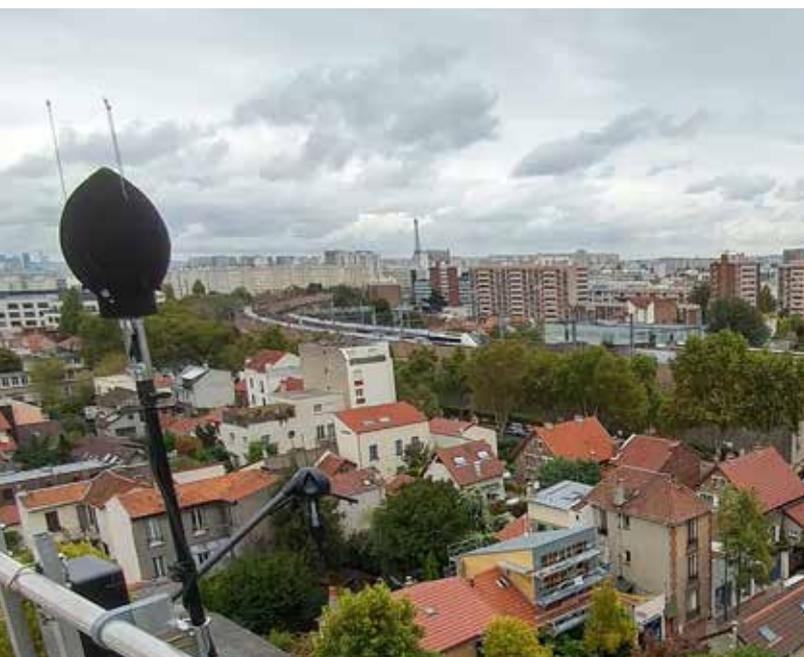
Réalisées sur le terrain à l'aide de sonomètres ou de stations automatiques, les mesures permettent d'analyser finement les variations du bruit au cours du temps, seconde après seconde et de faire la distinction entre les niveaux de bruit de fond, les passages de trains et les autres événements ponctuels. Les résultats des mesures permettent ainsi de déterminer la contribution de chaque source de bruit en présence.
