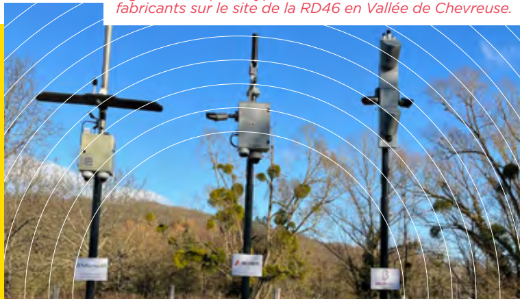
Figure 1 : Les prototypes de radars sonores des trois fabricants sur le site de la RD46 en Vallée de Chevreuse.
