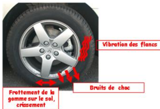
Figure 1.6 : Bruit dû aux vibrations du pneumatique (source : COLAS).
