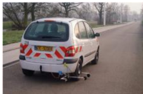
Figure 2.41 : Mesure du bruit de roulement en continu, [4].
