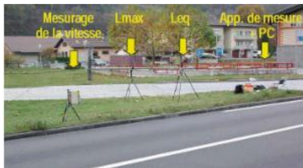
Figure 2.35 : Méthode statistique au passage (ISO 11819 - 1), [2].
