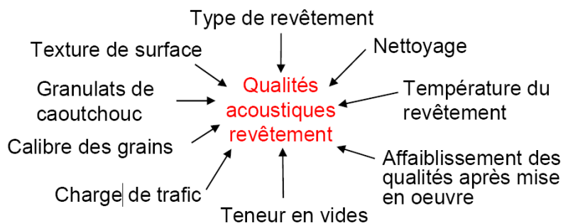
Figure 2.2 : Eléments d'amélioration des performances acoustiques, [2].
