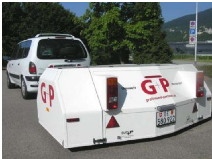
Figure 2.37 : Remorque de mesure CPX, [2].
