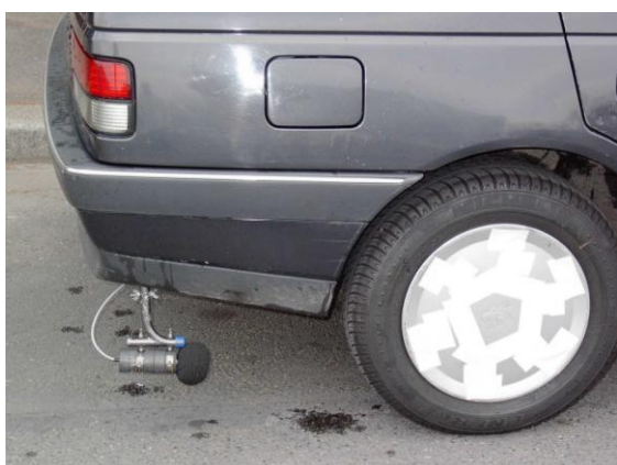
Figure 3.14 : Mesure du bruit de roulement en continu, [47].
