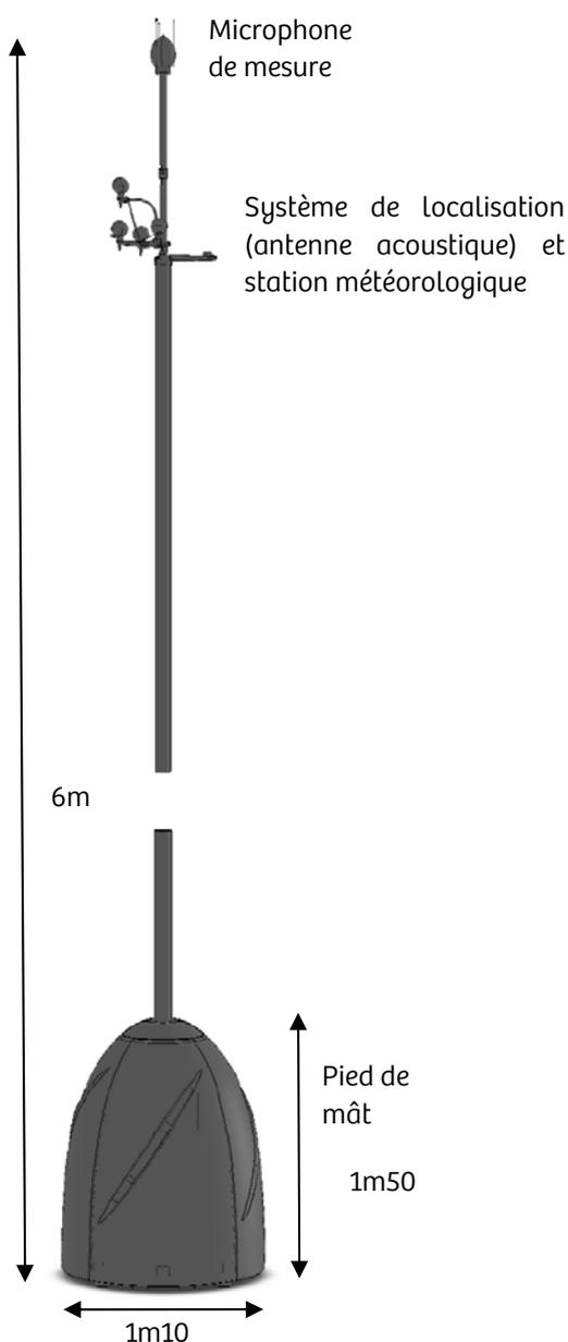
Le Sonopode® se compose principalement d'un mât de 6 mètres et d'une double enveloppe anti-vandalisme située à son pied.
